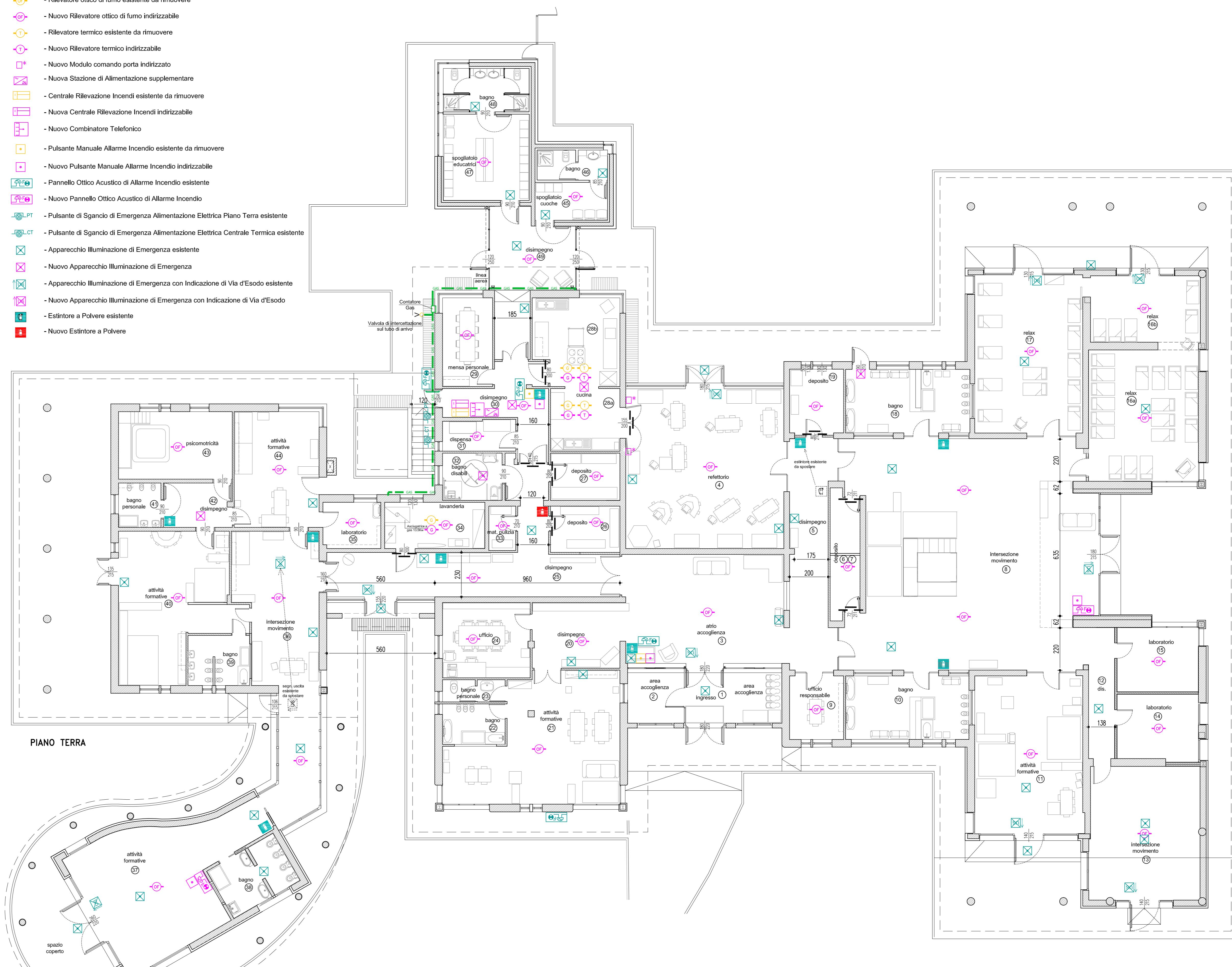
NOTA 1: L'IMPIANTO ELETTRICO, L'IMPIANTO DI ILLUMINAZIONE DI EMERGENZA, L'IMPIANTO DI RILEVAZIONE INCENDI E L'IMPIANTO DI ALLARME, DEVONO ESSERE INTEGRATI PER GLI ELEMENTI MANCATI E/O DA SOSTituIRE AL FINE DEL RILASCIO FINALE DELLA DICHIARAZIONE DI CONFORMITA' PER LA PARTE DI IMPIANTO AMPLIATA E LA DICHIARAZIONE DI RISPONDENTI PER LA PARTE DI IMPIANTO ESISTENTE. I NUOVI INTERVENTI E LA REVISIONE INCLUDONO LA POSA DELL'IDONEA CARTELLONISTICA OVE MANCANTE O NON CONFORME.
